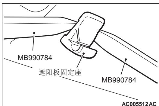
将专用工具装饰件拆卸器（MB990784）从左右两侧插入遮阳板固定件，以分开遮阳板固定件侧面的卡爪。
